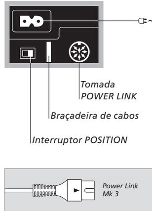
**Tomada POWER LINK:** Utilize esta tomada para ligar a coluna a uma das tomadas Power Link do sistema Bang & Olufsen.
