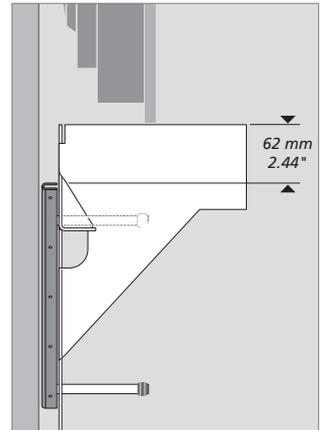
**"Ferramenta" de cartão:** A "ferramenta" é utilizada como auxiliar de posicionamento do suporte de parede à distância correcta da extremidade inferior do ecrã de televisão.
