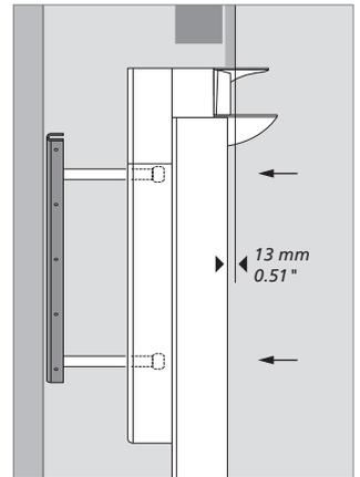
**Posição da coluna:** O suporte de parede permite-lhe ajustar a posição da coluna, para a frente e para trás, para utilização com ecrãs de televisão de tamanhos diferentes. Por razões de segurança, é importante que bloqueie a coluna no suporte de parede!
